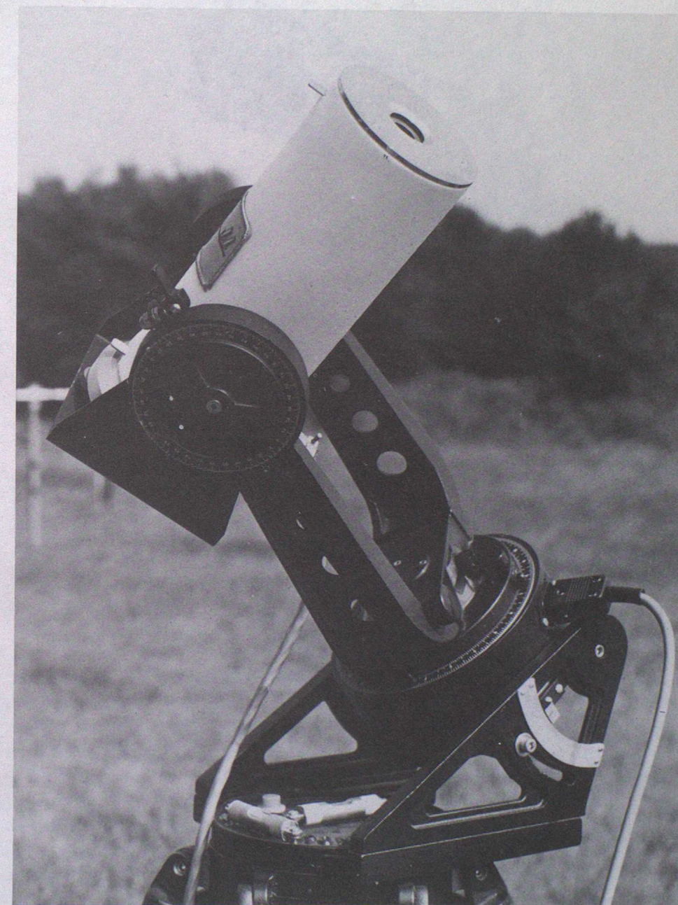
Plate VI. Kendall pyreheliometer Mk 6.
